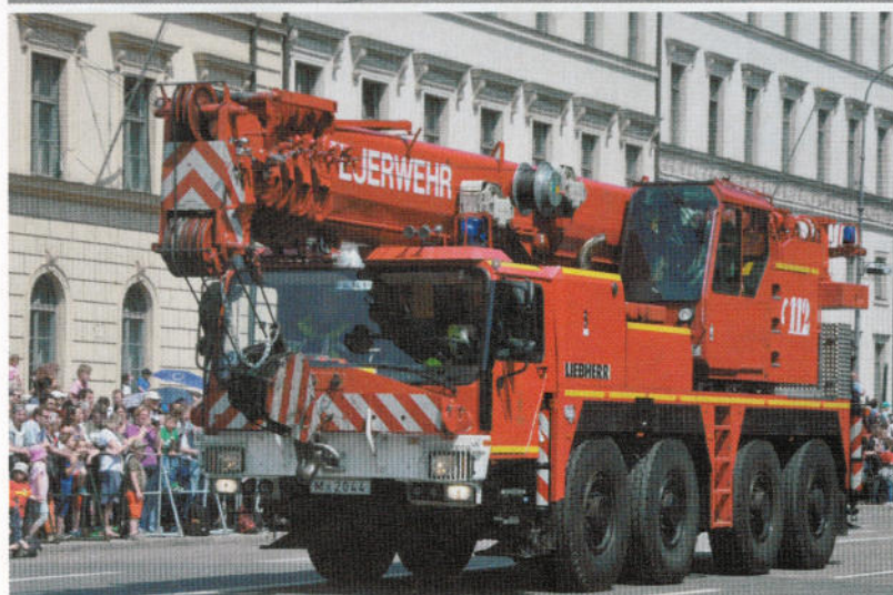
3. L'une des plus belles « pièces » du défilé ! Armé par les sapeurs-pompiers professionnels de Munich, ce camion-grue permet de lever des charges de 70 tonnes.
